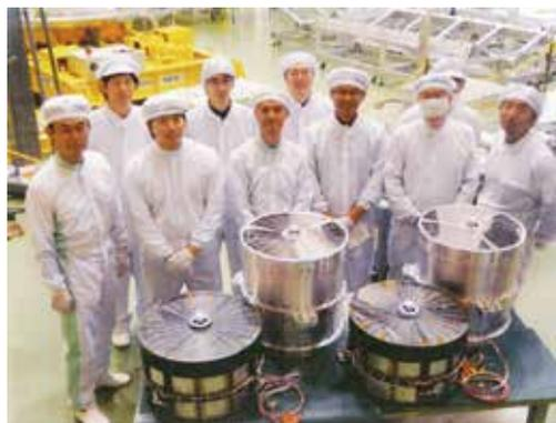
つくば宇宙センターに勢ぞろいしたX線望遠鏡。奥が硬X線望遠鏡、手前が軟X線望遠鏡。軟X線望遠鏡はNASAゴダード宇宙飛行センターを中心に開発されました。
